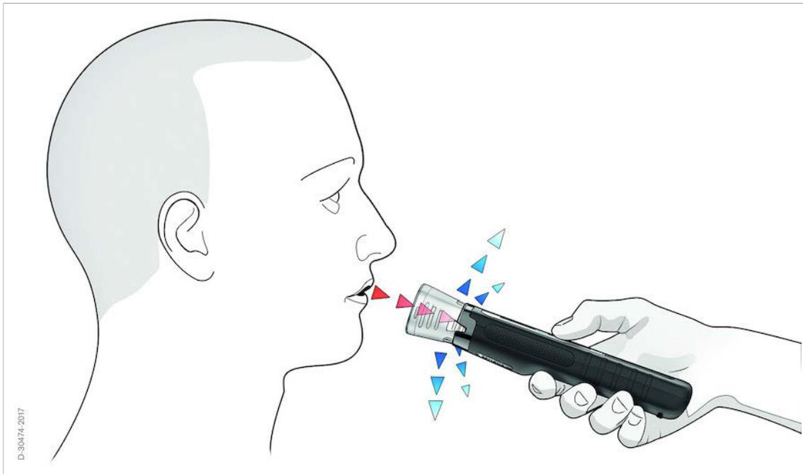
Специальный мундштук-воронка уменьшает обратный поток выдыхаемого воздуха, направленный на лицо испытуемого. Это гигиеническое новшество снижает риск взаимного заражения испытуемых.
